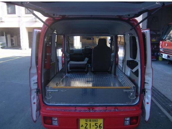
後部座席を収納、収納ボックスのピンを解除し枠を拡張し、助手席座席を倒すことで収納スペース拡大。
