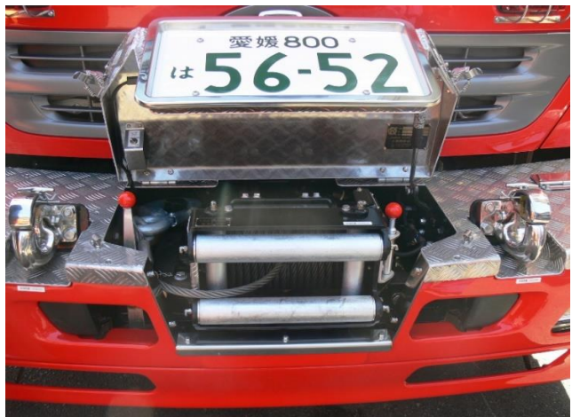
車両前・後部にウィンチ、後部にクレーンを装備しています。
