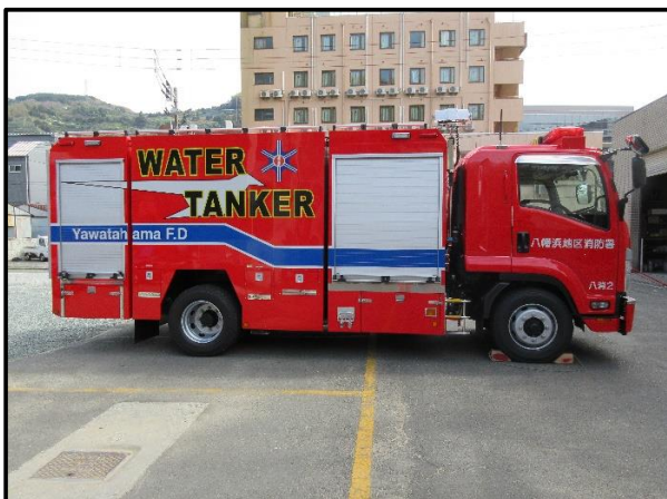
「PP製の6000リットル水槽」 PP製のため軽量で衝撃にも強い 水量をギリギリまで増量！！
