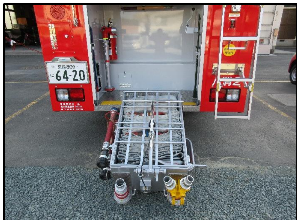
「ホースらく車積載」 約180mのホースを積載しており 1人でも長距離のホース延長が可能
