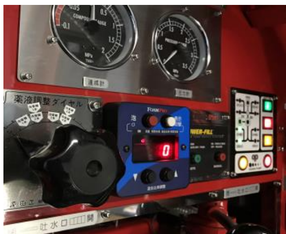
自動泡混合装置(フォームプロ) ワンタッチでクラスA泡消火薬剤が使用可能
