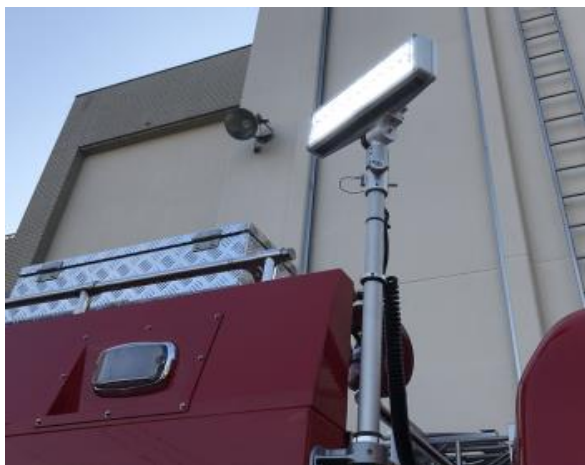
照明灯(LED式) 長尺伸縮柱付き
