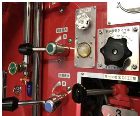
ポンププロポーションナー クラスB火災事案にも万全の装備
