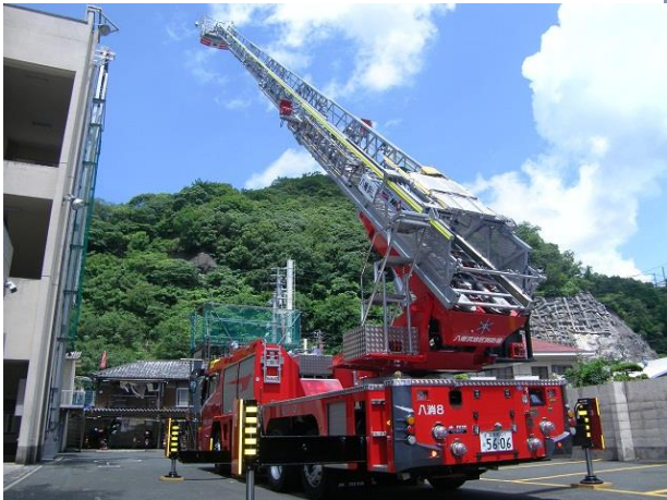
梯子を起伏・伸梯させた状況
