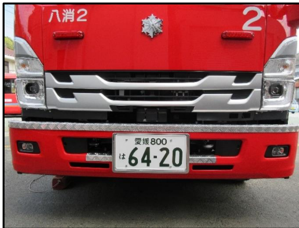
「衝突防止装置設置」 前方車両との距離を測定し安全運転が可能
