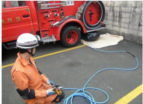
約50tの重量物も持ち上げられるエアージャッキ
