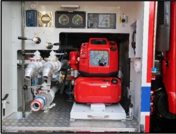
「小型ポンプ」 B2級適合品で4ストロークエンジンのため、 運転時の騒音を軽減
