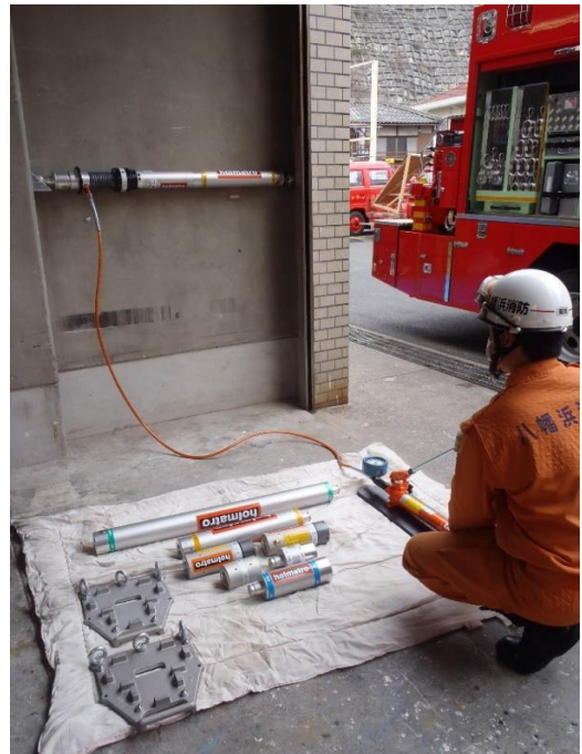
金属等を切断したり押し拡げたりできる油圧救助器具
